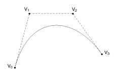
$$Q''(t) = \begin{bmatrix} 6t & 2 & 0 & 0 \end{bmatrix} \begin{bmatrix} -1 & 3 & -3 & 1 \\ 3 & -6 & 3 & \\ -3 & 3 & & \\ 1 & & & \end{bmatrix} \begin{bmatrix} V_0 \\ V_1 \\ V_2 \\ V_3 \end{bmatrix}$$
