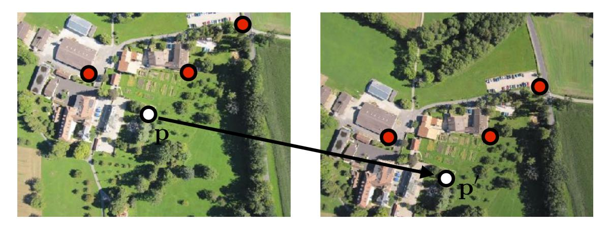
$$\begin{bmatrix} x_1' \\ y_1' \\ 1 \end{bmatrix} = \begin{bmatrix} a_{11} & a_{12} & a_{13} \\ a_{21} & a_{22} & a_{23} \\ 0 & 0 & 1 \end{bmatrix} \begin{bmatrix} x_1 \\ y_1 \\ 1 \end{bmatrix}$$
