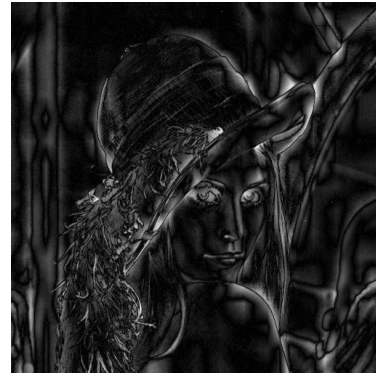
(d) JPEG2000 Rate 0.001; Compression 1000:1 ; PSNR = 20.27 dB
