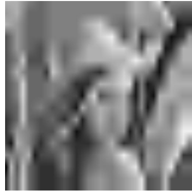
(d) JPEG2000 Rate 0.001; Compression 1000:1 ; PSNR = 20.27 dB
