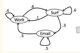
$\begin{bmatrix} q_W^{(t)}, q_S^{(t)}, q_E^{(t)} \end{bmatrix} \bigvee \begin{bmatrix} 0.4 & 0.6 & 0 \\ 0.1 & 0.6 & 0.3 \\ 0.5 & 0 & 0.5 \end{bmatrix}$
